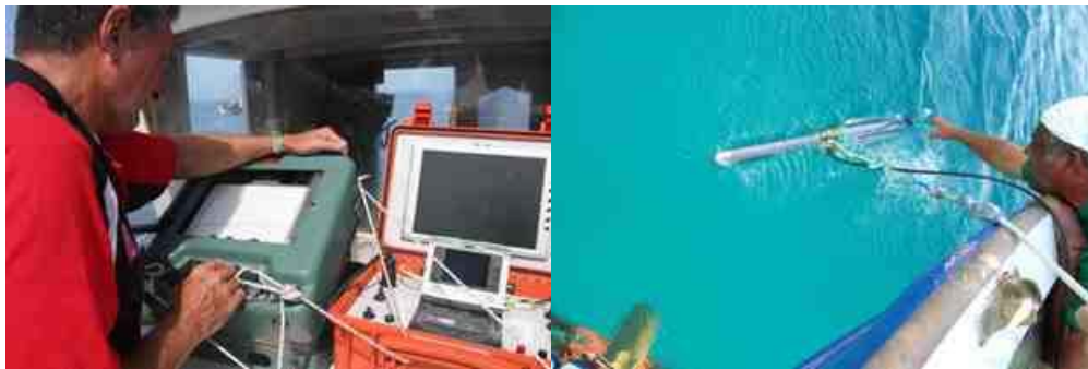
Βύθιση σόναρ και υδρογραφική απεικόνιση σε μόνιτορ θαλάσσιων λιβαδιών Ποσειδωνίας
