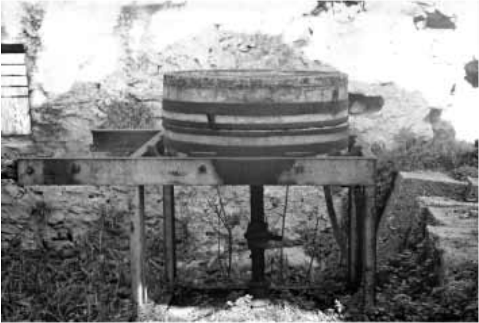
Αλεστικός μηχανισμός (σπαστήρας) στο μύλο του Καριοφύλλι (φωτο. αρχείο: Π. Σελέκος)
